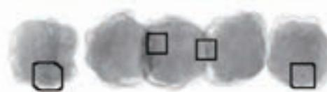
○通常のソフトウェアにより、硬骨の検知は出来ているが、重なった部分で誤検知も発生している。
